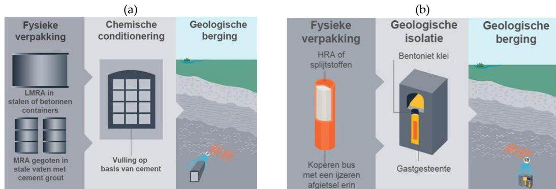
Figuur 19 Afbeeldingen van voorbeelden van meervoudige barrièresystemen zoals gebruikt voor (a) middelradioactief afval en (b) hoogradioactief afval en verbruikte splijtstoffen (op basis van een figuur uit: (Nuclear Decommissioning Authority (NDA), 2010)).
