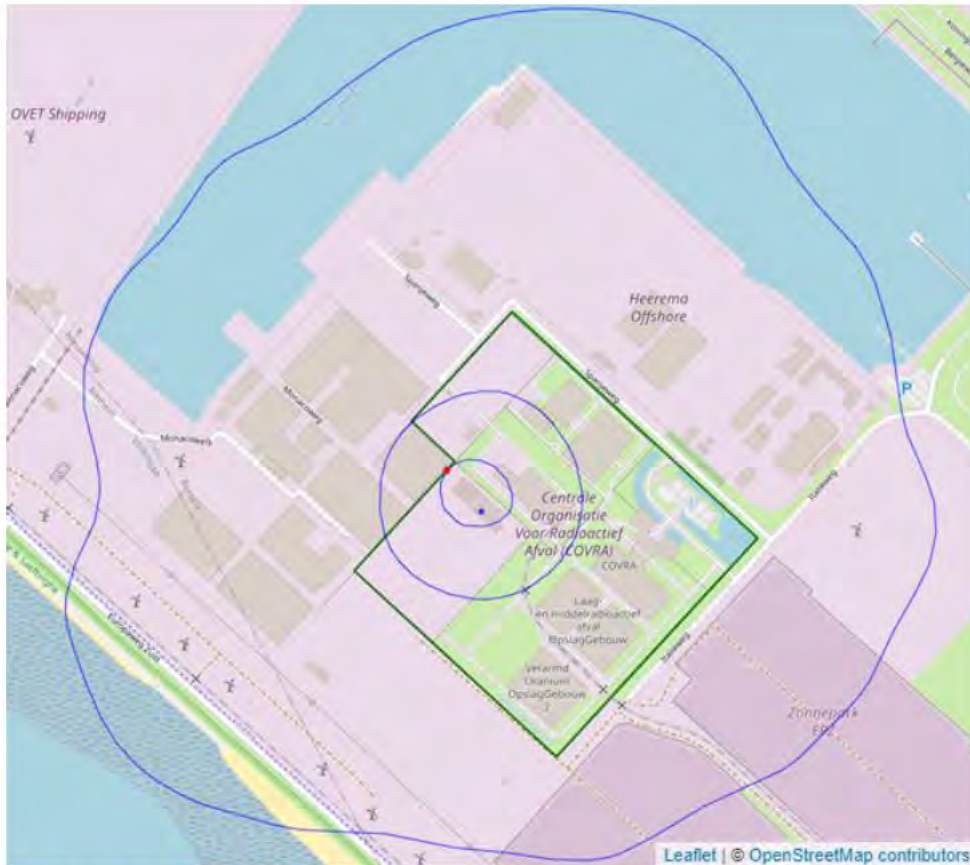
Figuur 6-1: Dosiscontouren 2,6 \cdot 10^{-9} Sv/jaar (terreingrens maximum, locatie rode stip), 3,3 \cdot 10^{-10} Sv/jaar (1/8 van terreingrens maximum) en 4,1 \cdot 10^{-11} (1/64) t.g.v. reguliere emissie uit het MOG.
