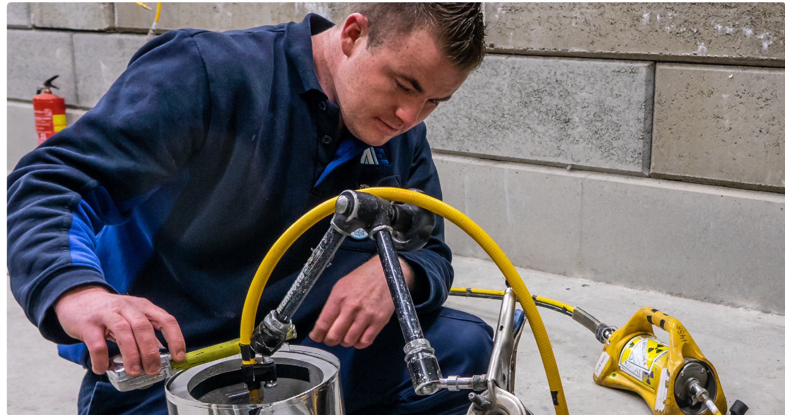
Materiaalonderzoek met een hoogactieve radioactieve bron.
