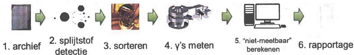
Figuur 4 Schematische weergave van de processtappen van het RAP-Karakterisatieproces
