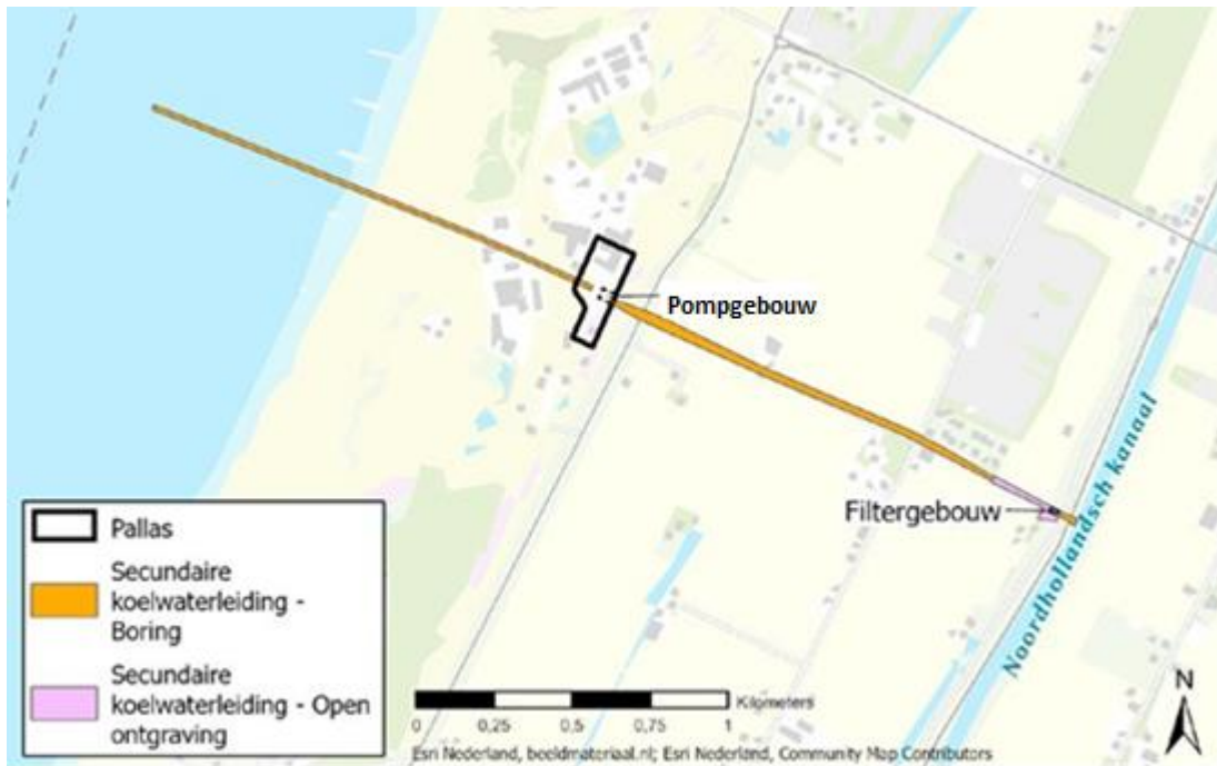
Figuur 4-5 Ligging van de secundaire koelwaterleidingen, Pompgebouw en Filtergebouw
