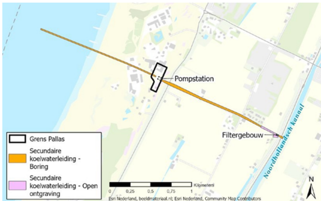
Figuur 7 Tracé van de koelwaterleiding (van filtergebouw (Canal Intake Building) via pompstation (SCS-building met surgetower) naar de Noordzee ten behoeve van de PALLAS-reactor. Aan het oostelijke uiteinde bevindt zich het onttrekkingspunt in het Noordhollandsch Kanaal, aan het westelijke uiteinde (circa 650 m uit de Rijkstrandpalenlijn) het lozingspunt in de Noordzee.
