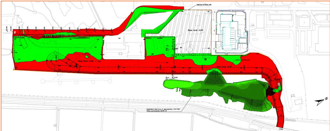
Figuur 6 Overzicht grondstromenplan: rood is afgraven en groen is ophogen (bron: Grondstromenplan TCF, Arcadis, 12 juli 2019)
