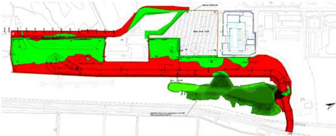
Figuur 19 Overzicht Grondstromenplan: rood is afgraven en groen is ophogen (Bron: Grondstromenplan TCF, Arcadis, 12 juli 2019)
