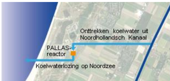
Figuur 15 Schematische weergave secundair koelsysteem
