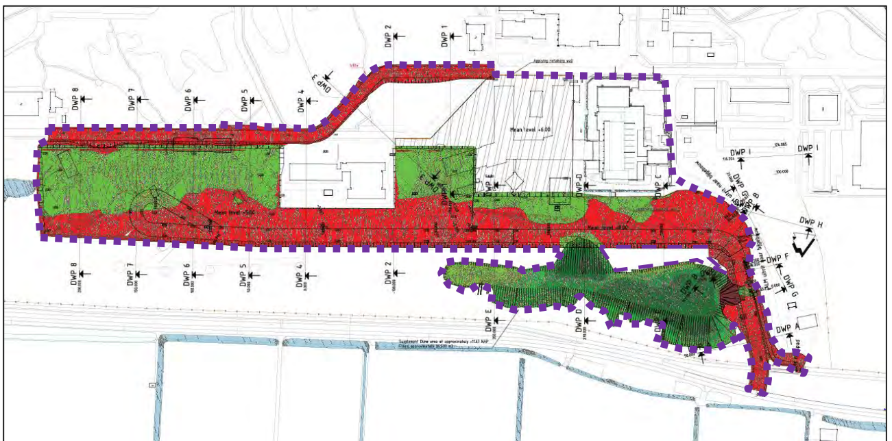
Figuur 2-8 Verplaatsing van zand in het projectgebied (grondstroomplan). Rood geeft aan waar zand wordt afgegraven, groen waar zand wordt aangebracht. De onderbroken, paarse lijn geeft aan waar grondverzet mogelijk is.
