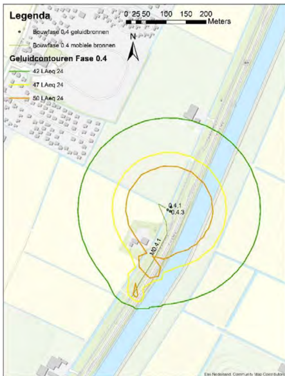
Figuur 12: Geluidscontouren voor de werkzaamheden aan het filterhuis (werkzaamheden langs kanaal).
