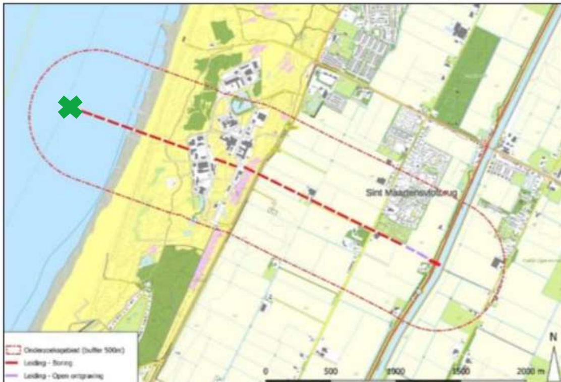
Afbeelding 2: Ligging van het koelwatertracé volgens figuur 4 van de soortenbeschermingstoets. Op de locatie van het groene kruis komt de uitlaat. Zie voor details uitlaatpunt figuur 6 in soortenbeschermingstoets. Let op: het grootste deel van de leidingen ligt ondergronds (rode onderbroken lijn). Slechts een klein deel wordt open ontgraven (paarse onderbroken lijn). Zie voor het werkgebied langs het kanaal figuur 9 in de Soortenbeschermingstoets.
