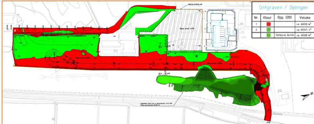
Figuur 2 Overzicht Grondstromenplan: rood is afgraven en groen is ophogen (bron: Grondstromenplan TCF, (Arcadis, 12 juli 2019).
