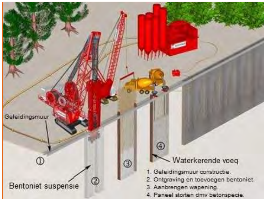
Figuur 6 Werkwijze aanbrengen diafragma muren.
