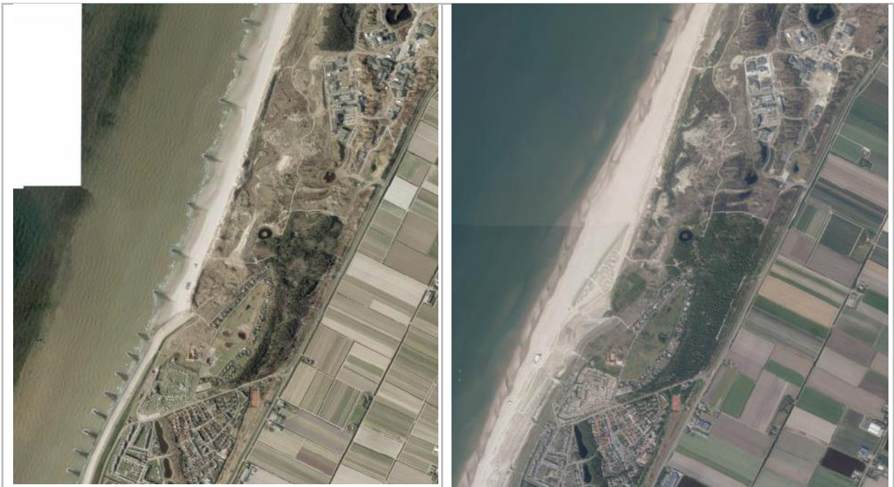
Figuur 6-1 Luchtfoto's van de Pettemerduinen voor en na de uitvoering van het project Hondsbossche Duinen (links 2010, rechts 2021). Zichtbaar is dat er op de kust van de Pettemerduinen aanzienlijk meer zand aanwezig is (Bron: topotijdreis.nl).
