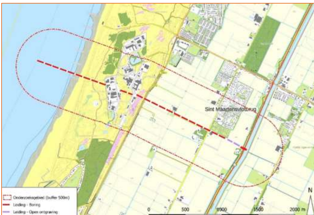
Figuur 2-4 Koelwaterleidingentracé. De rode onderbroken lijn geeft het te boren deel aan, de paarse onderbroken lijn het deel dat met open ontgraving wordt aangelegd. Aan het meest oostelijke uiteinde komt het filterhuis met innameconstructies en aan de meest westelijke uiteinde het uitlaatpunt 650 meter uit de Rijkstrandpalenlijn (RSP). 2
