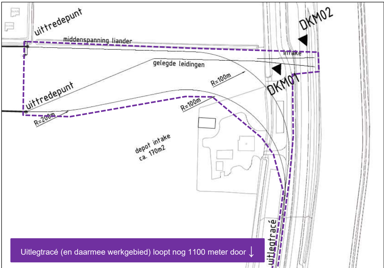
Figuur 2-9 Schematische weergave van de situatie bij de aanleg van de koelleiding nabij het Noordhollandsch Kanaal. Vanaf de uittredepunten tot aan de N9 worden de leidingen met een open ontgraving neergelegd. Onder de N9 wordt weer doorgeboord. Het uitlegtracé is langs een afstand van ongeveer 1200 meter naar het zuiden langs de Parallelweg gelegen. Uitgangspunt is dat werkzaamheden binnen de onderbroken, paarse lijn plaatsvinden.
