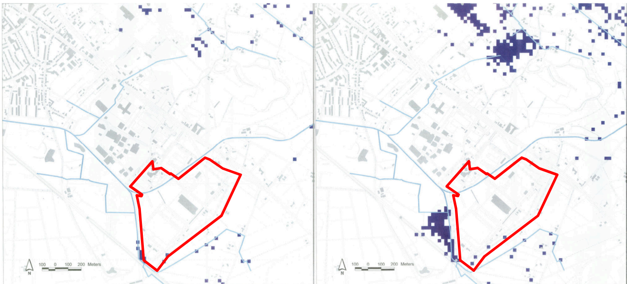
Figuur 2-6 Indicatieve overstromingen eens per 100 jaar (links) en eens per 5.000 jaar (rechts). De rode lijn geeft het Urenco terrein weer, de blauwe vlekken geven watergebieden weer
