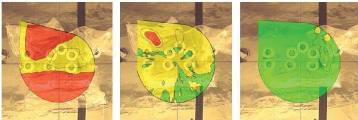
Figuur 5 Voorbeeld van HIRARCHI gamma scans ten behoeve van het scheiden van RAP-afval
