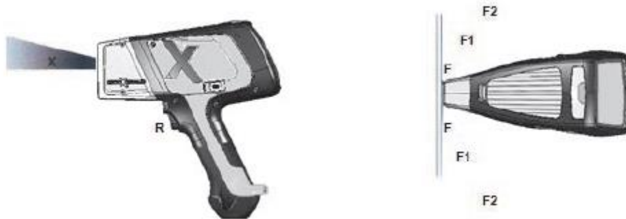
Foto 4: X-ray bundel en meetpunten strooiestraling
