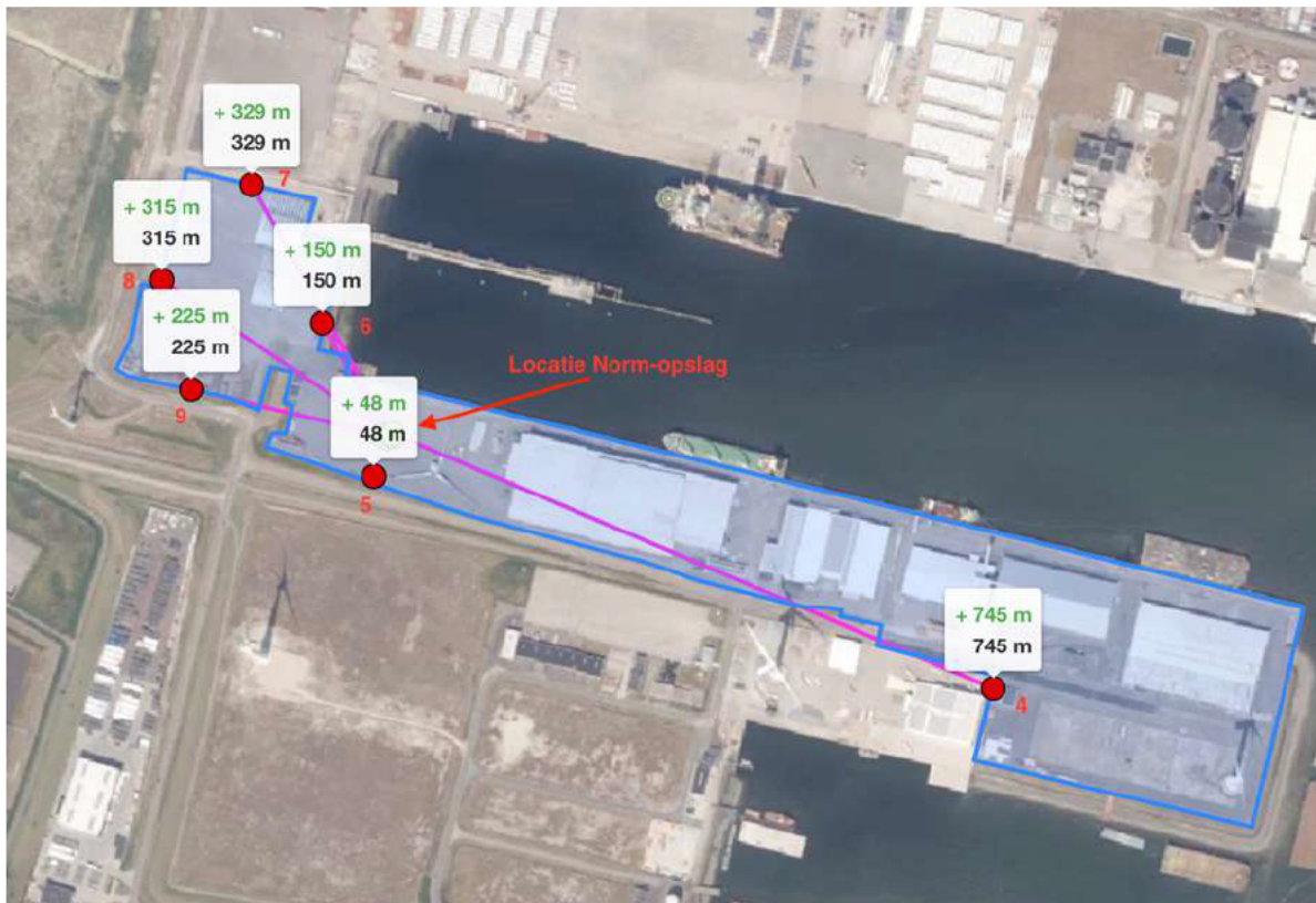
Afbeelding 4 Locatietekening met afstanden tot kritieke plaatsen (rode bollen) vanaf NORM-opslag (rode pijl)
