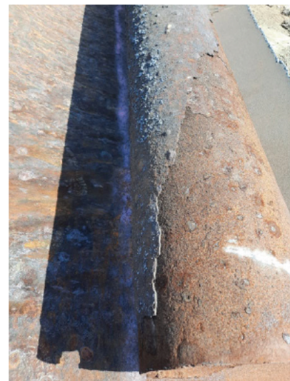
Foto 1 en 2 Typische materialen uit de Olie- en Gasindustrie welke met NORM besmet zijn
