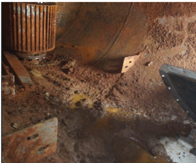
Foto 1 en 2 Typische materialen uit de Olie- en Gasindustrie welke met NORM besmet zijn
